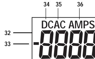
**Nota:** se indican en la pantalla TightSight™ únicamente las unidades de medida de corriente CC y CA (amperes), porque su uso principal es para observar medidas de corriente en lugares estrechos. La pantalla mostrará los valores numéricos para las otras funciones únicamente. Para ver las unidades de medida de todas las demás funciones se debe utilizar la pantalla principal.
