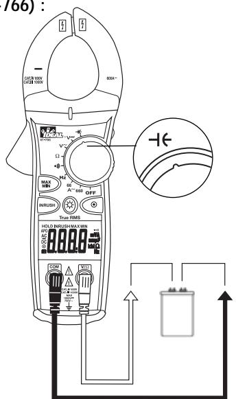
Remarque : Si "disc" est affiché il y a de la tension dans le condensateur. Décharger le condensateur et réinitialiser l'essai.
