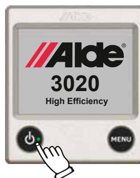
Un indicateur DEL s'illumine à proximité du bouton Marche/Arrêt lorsque le panneau et le système de chauffage sont en marche.
