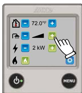
2. **Opération normale.** Si l'eau chaude est requise, appuyer sur le bouton « + » (le symbole deviendra ombragé). Si la fonction au chapitre 2.9, section 12 (chauffage du plancher\*) a été réglé à Cont., cette option ne peut pas être sélectionnée. Lorsque seule de l'eau chaude est requise, p. ex. pendant l'été ou lorsque le chauffage n'est pas nécessaire, aucun réglage ne doit être fait; le système de chauffage traite automatiquement cette fonction.
