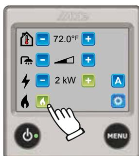
1. Démarrer le fonctionnement au gaz en appuyant sur le symbole de la flamme. Le fonctionnement au gaz est activé et le symbole de la flamme change de couleur et passe au vert.
