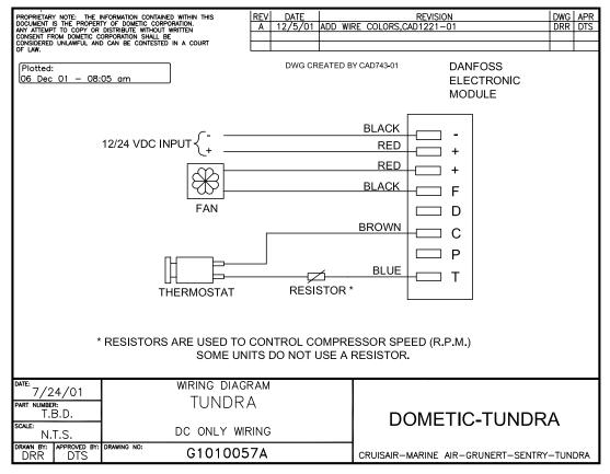
\* Note: T18 & T22 Models use a 277-ohm resistor.
